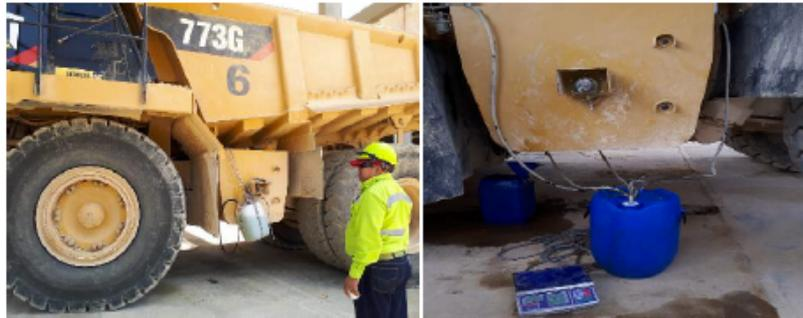
Ces réservoirs externes ont été conditionnés pour connecter les tuyaux d'aspiration et de retour du système d'injection.
