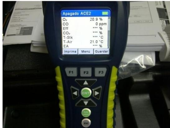
Fig. 1 Instrumento de medición de gases
