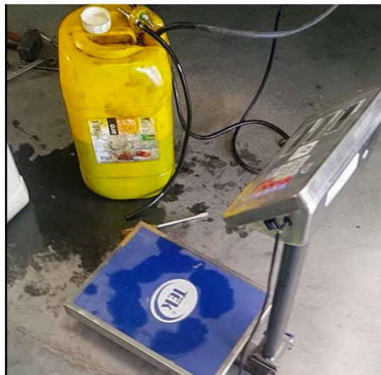
Ilustração 3. Ajuste do recipiente para o teste com fluxo de diesel.
